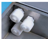
Trois flotteurs de niveaux : marche/arrêt/alarme
